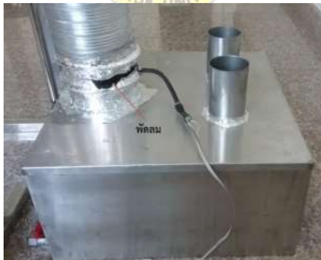
ภาพที่ 4.2 ถังบรรจุสารดูดซับที่สร้างตามแบบร่างที่ 3 ของโครงสร้างถังบรรจุสาร
