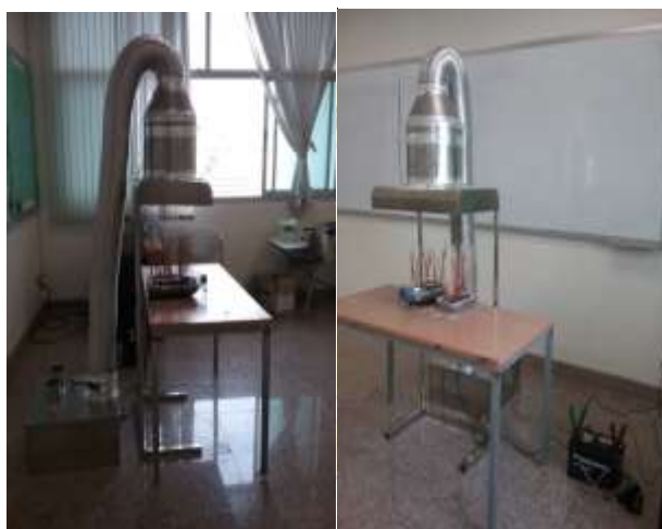
ภาพที่ 3.7 เครื่องดูดควันที่จัดตั้งเรียบร้อยพร้อมทดสอบการใช้งาน
