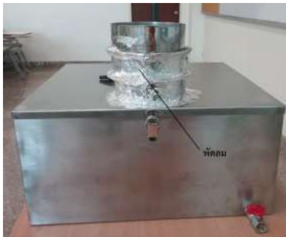
ภาพที่ 4.1 ถังบรรจุสารดูดซับที่สร้างตามแบบร่างที่ 2 ของโครงสร้างถังบรรจุสาร
