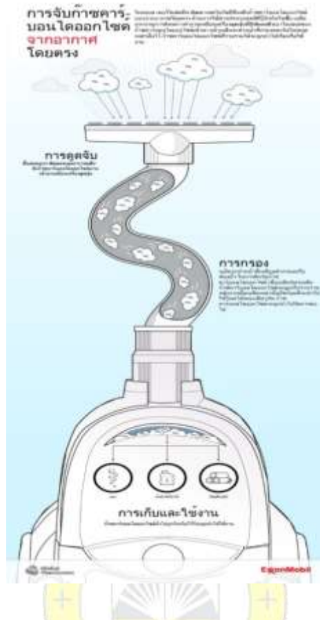
ภาพที่ 2.9 เครื่องดูดดูดก๊าซคาร์บอนไดออกไซด์ (CO 2 ) ออกจากอากาศ
