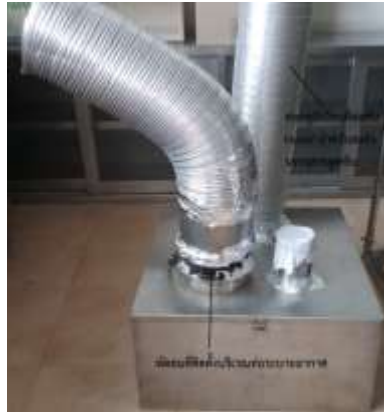
ภาพที่ 4.3 ถังบรรจุสารดูดซับที่ย้ายพัฒลมาจากบริเวณ Hood มาติดบริเวณที่ระบายอากาศ
