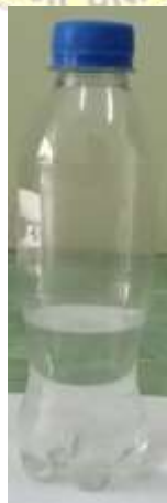
ภาพที่ 4.33 สารละลายแคลเซียมไฮดรอกไซด์หลังนำมาจ่อปลายปล่องท่อระบายอากาศ
