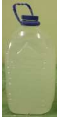
ภาพที่ 4.38 สารดูดซับมีสีขาวขุ่นและมีของแข็งสีขาวแขวนลอยในสารดูดซับ
