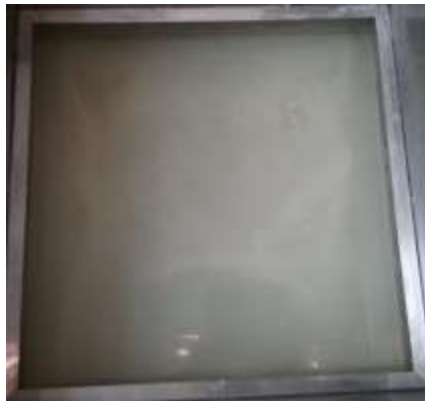
ภาพที่ 4.5 ฝาสีขาวขุ่นผิวหน้าสารดูดซับ (วันแรก)
