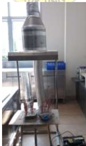
ภาพที่ 4.4 เครื่องดูดควันที่ปรับปรุงถังบรรจุสารดูดซับนำมาทดสอบประสิทธิภาพ
