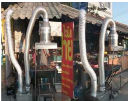
ภาพที่ 4.32 เครื่องดูดควันที่ติดตั้งพร้อมใช้ทดลอง
