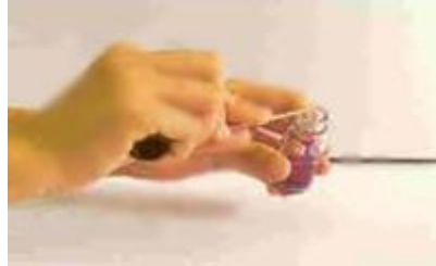
ภาพที่ 2.3 การหักไม้พ้นสำลีลงในขวดน้ำยา SI-2
