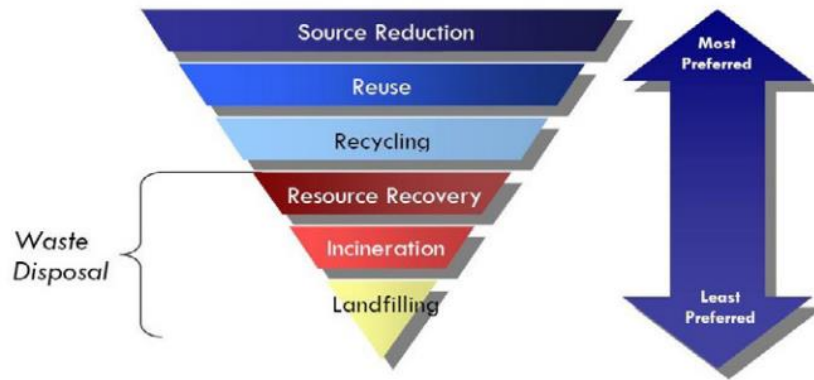
ภาพที่ 2.1 ลำดับการจัดการขยะมูลฝอยตามหลักการ 3 R
