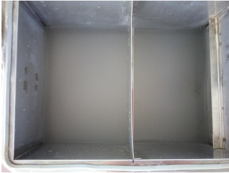
ภาพที่ 4.12 ฝาสีขาวชุ่นของแคลเซียมคาร์บอเนต ที่ลอยอยู่ผิวหน้าของสารละลายในถังบรรจุสาร จากการทดสอบวันที่หก
