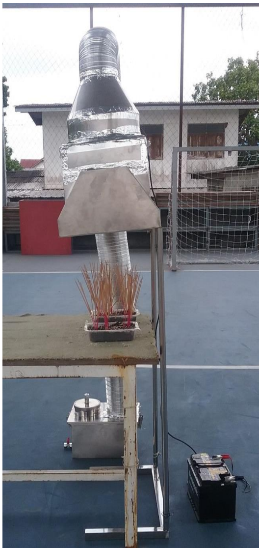
ภาพที่ 4.1 เครื่องดูดควันที่สร้างตามแบบร่างที่ 2 ของโครงสร้างเครื่องดูดควัน
