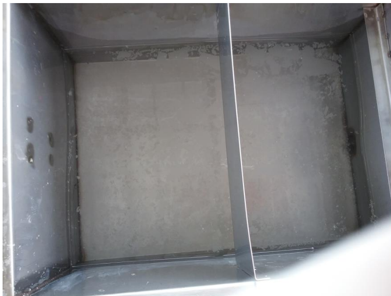
ภาพที่ 4.7 แคลเซียมคาร์บอเนตแผ่นบางแตกกระจาย จากการกวนน้ำหรือเขย่าถังบรรจุสาร จากการทดสอบวันที่สาม
