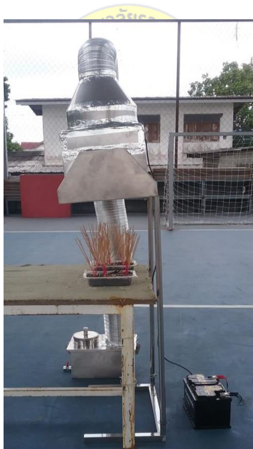
ภาพที่ 3.8 เครื่องดูดควันที่ติดตั้งเรียบร้อยแล้ว พร้อมทดสอบ
