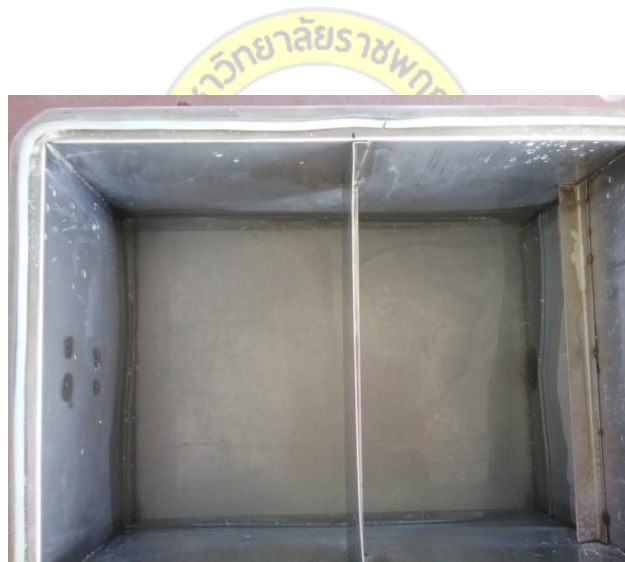
ภาพที่ 4.9 แคลเซียมคาร์บอเนตแผ่นบางขนาดเล็ก ๆ แตกกระจาย จากการกวนน้ำหรือเขย่าถังบรรจุสาร จากการทดสอบวันที่สี่
