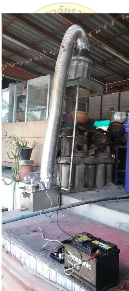
ภาพที่ 4.2 เครื่องดูดควันที่สร้างตามแบบร่างที่ 3 ของโครงสร้างเครื่องดูดควัน
