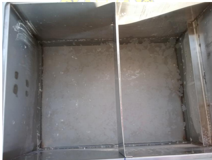
ภาพที่ 4.5 แคลเซียมคาร์บอเนตแผ่นบางแตกกระจาย จากการกวนน้ำหรือเขย่าถังบรรจุสาร จากการทดสอบวันที่สอง
