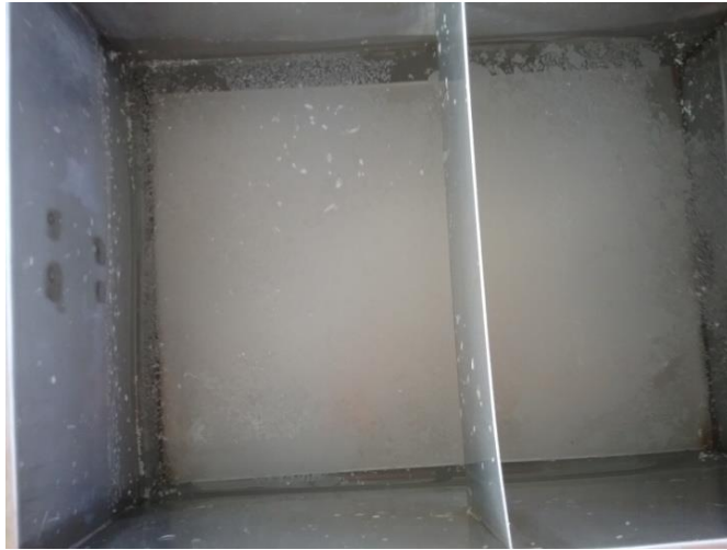
ภาพที่ 4.14 แคลเซียมคาร์บอเนตแผ่นบางขนาดเล็ก ๆ ค่อนข้างละเอียดแตกกระจาย จากการกวน น้ำหรือเขย่าถึงบรรจุสาร จากการทดสอบวันที่หก
