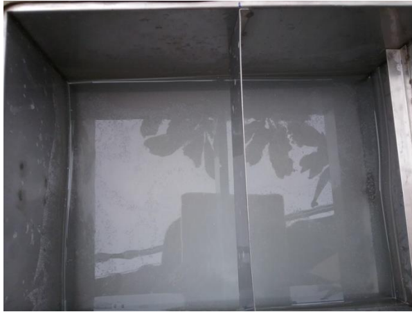
ภาพที่ 4.17 แคลเซียมคาร์บอเนตสีขาวขุ่นที่แขวนลอย บางส่วนเป็นแผ่นฝ้าขาวขุ่นลอยผิวหน้า จากร้านขายส้มตำคอหมุย่าง
