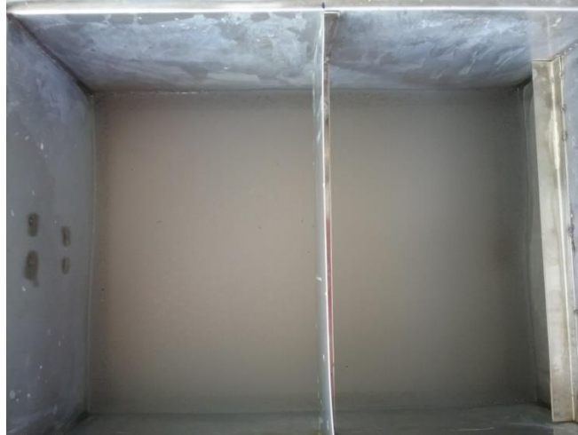
ภาพที่ 4.10 ฝ้าสีขาวขุ่นของแคลเซียมคาร์บอเนต ที่ลอยอยู่ผิวหน้าของสารละลายในถังบรรจุสาร จากการทดสอบวันที่ห้า
