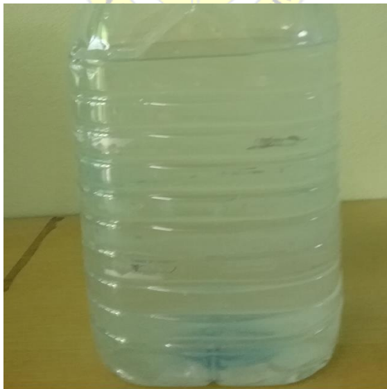
ภาพที่ 3.6 สารละลายแคลเซียมไฮดรอกไซด์ส่วนที่ใส
