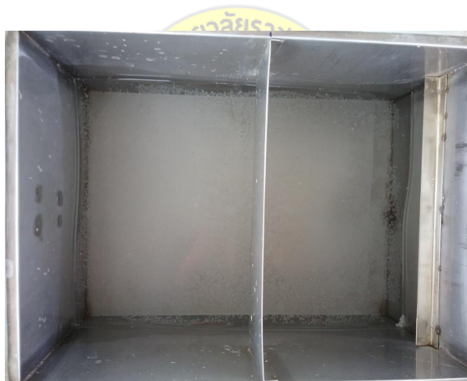
ภาพที่ 4.14 แคลเซียมคาร์บอเนตแผ่นบางขนาดเล็ก ๆ ค่อนข้างละเอียดแตกกระจาย จากการกวน น้ำหรือเขย่าถึงบรรจุสาร จากการทดสอบวันที่หก
