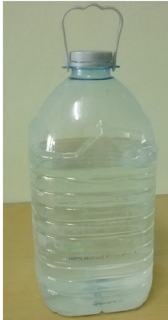
ภาพที่ 4.19 แคลเซียมคาร์บอเนตสีขาวขุ่นตกตะกอนลงมาที่ก้นขวดพลาสติก เมื่อตั้งทิ้งไว้อย่างน้อย 30 นาที จากร้านขายส้มตำคอหมูย่าง
